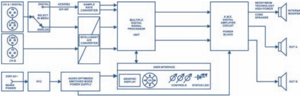
Die vollständig digitale Systemeinheit VSS 15, mit integriertem 15" Subwoofer, wurde konsequent nach portablen Anforderungen entwickelt. Im Inneren arbeiten ein digitaler 24 Bit Signalprozessor und drei leistungsstarke Class D Endstufen mit unverfälschter, kristallklarer Klangqualität (ohne Wandlungsverluste dank Digitaleingang). Das analoge Eingangssignal wird durch intelligente 24 Bit AD-Wandler direkt in der Vorstufe digitalisiert und bleibt bis zur Verstärkung in digitaler Form erhalten.
